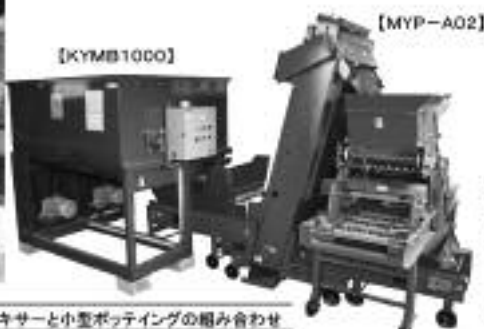
ミキサーと小型ポッティングの組み合わせ
